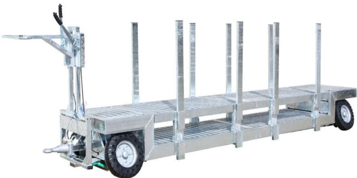
Foto 6 Trailer trolley voor micro tunnel
